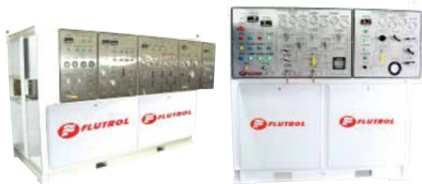
Painel Hidráulico para testes de BOP e ANM 10k, 20k, 30k. Cliente: GE oil&gas
